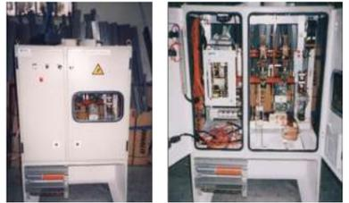
Armoire dédiée à une application de haute tension dans le milieu ferroviaire. Ici, l'intérêt est d'obtenir une accessibilité totale de tous les éléments internes à l'armoire. Notre bureau d'études a créé la solution : un système de portes permettant l'accès par tous les côtés de l'armoire tout en gardant la rigidité de l'ensemble.
