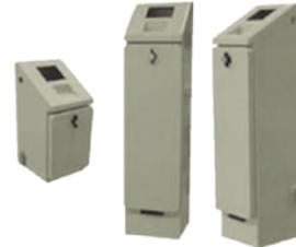
Pupitre polyester armé fibre de verre finition gel coat anti-UV. Stratification entre deux peaux polyester d'un maillage métallique cuivre assurant un écran aux perturbations électromagnétiques. Montage de ces bornes de contrôle d'accès au sol ou mural. Découpes et perçages réalisés sur mesure.
