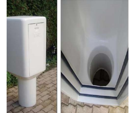
Borne en polyester armé fibre de verre avec isolation thermique mousse polyuréthane. Ces bornes permettent d'installer à l'intérieur de la robinetterie, raccords et autres éléments de plomberie. Grâce à l'isolation thermique intégrée les produits à l'intérieur de la borne sont hors gel. Un choix infini de teinte peut être réalisé permettant d'intégrer ce mobilier dans tous les sites.
