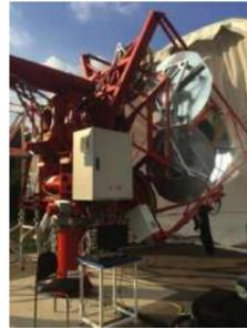
Europoly a réalisé des armoires couplées à des coffrets pour faire fonctionner des télescopes de très haute technologie. Nos produits ont été validés et commandés par l'observatoire de Paris. Il fallait à la fois des armoires et coffrets étanches mais ventilés (IP55 minimum) avec de très bonne tenue aux UV. Nous avons donc utilisé des grilles d'aération et ventilateur IP55. Nous avons peint les armoires avec un revêtement polyuréthane à très forte résistance aux UV.
